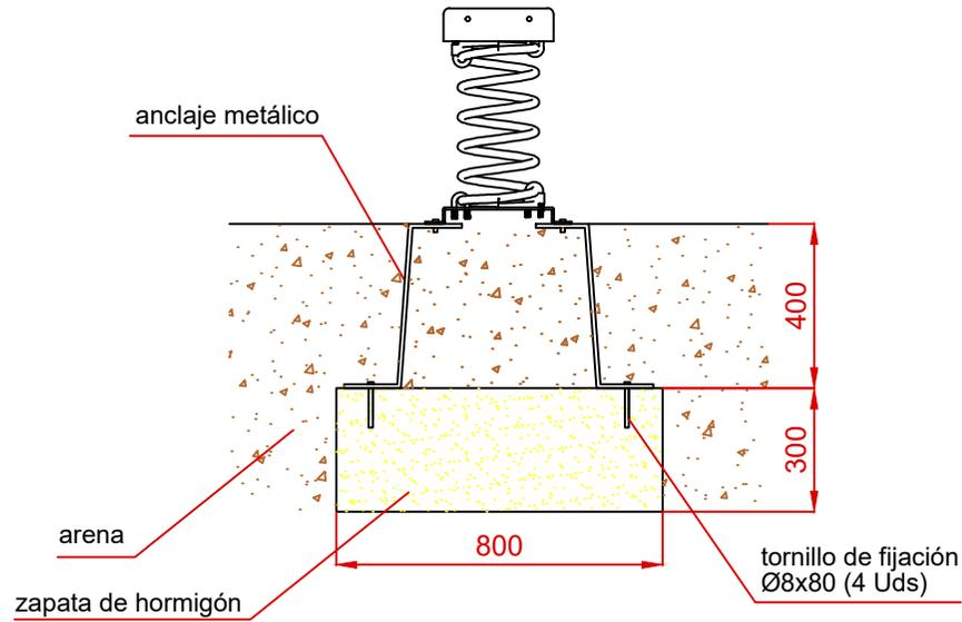
ESQUEMA DE CIMENTACIÓN EN HORMIGÓN
