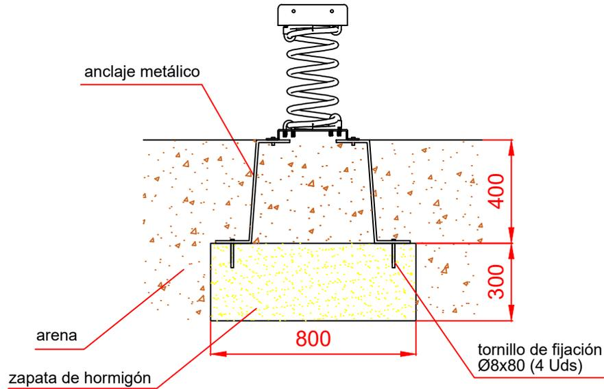
ESQUEMA DE CIMENTACIÓN EN HORMIGÓN
