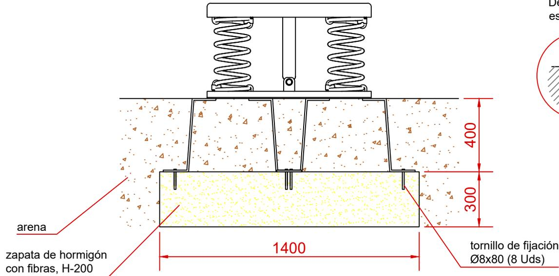
ESQUEMA DE CIMENTACIÓN EN HORMIGÓN
