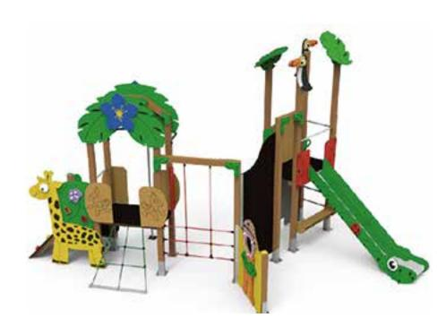
Altura libre de caída: 1,36 m Edad recomendada de uso: a partir de 3 años Madera de pino tratada en autoclave Nivel IV Componentes plásticos: Polietileno de alta densidad con protección UV Tubos de barrera y rampa de tobogán de acero inoxidable Componentes metálicos galvanizados Tornillería protegida con tapones de polipropileno
