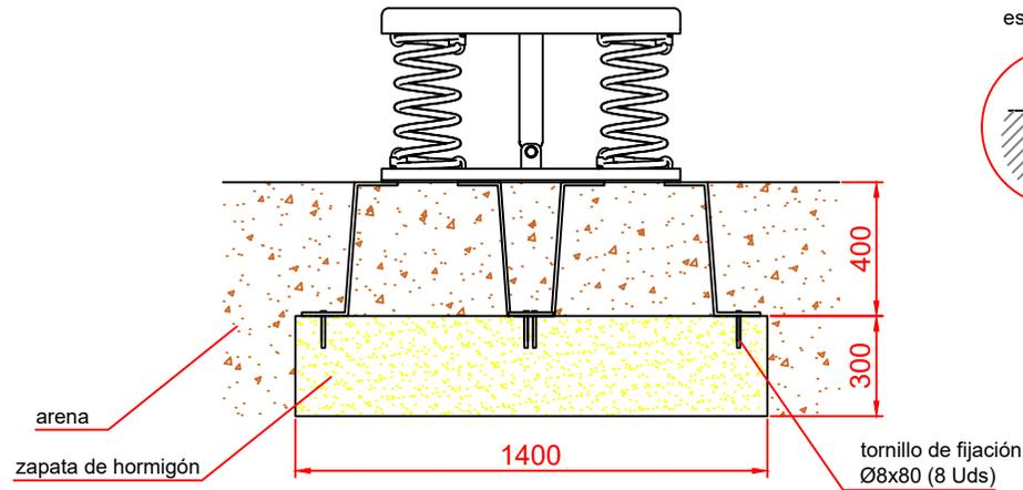
ESQUEMA DE CIMENTACIÓN EN HORMIGÓN
