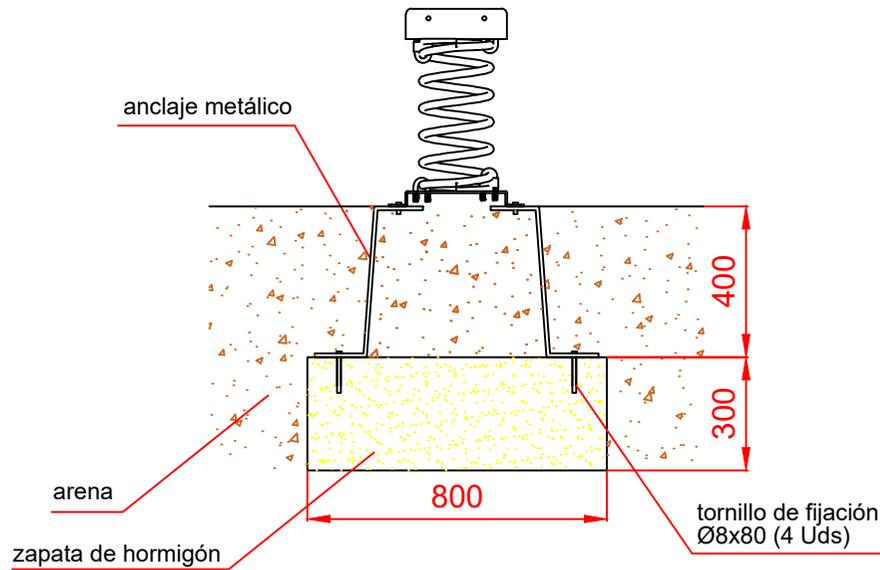
ESQUEMA DE CIMENTACIÓN EN HORMIGÓN
