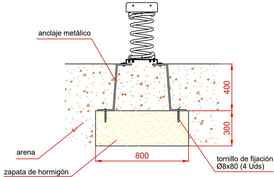
ESQUEMA DE CIMENTACIÓN EN HORMIGÓN
