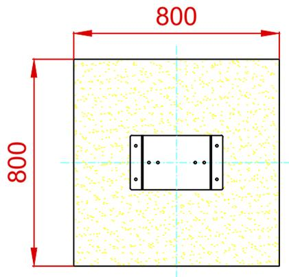
ESQUEMA DE CIMENTACIÓN EN HORMIGÓN
