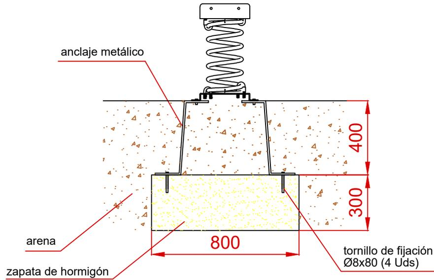
ESQUEMA DE CIMENTACIÓN EN HORMIGÓN
