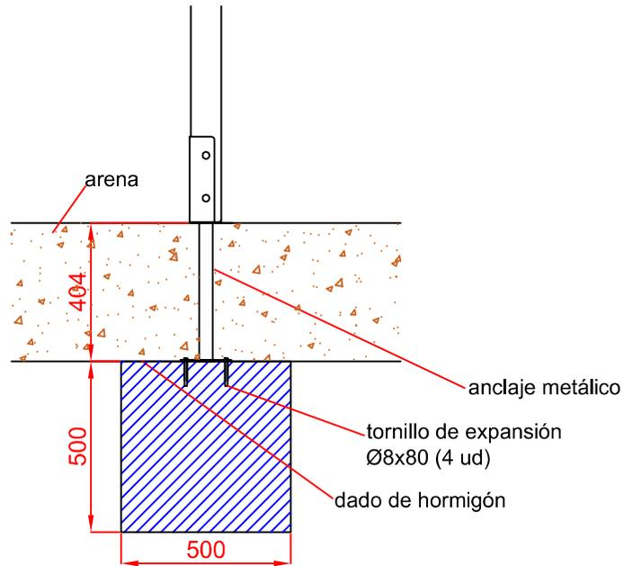
**ESQUEMA DE CIMENTACIÓN PARA CASOS EN LOS QUE VA ATORNILLADO SOBRE SOLERA DE HORMIGÓN**
