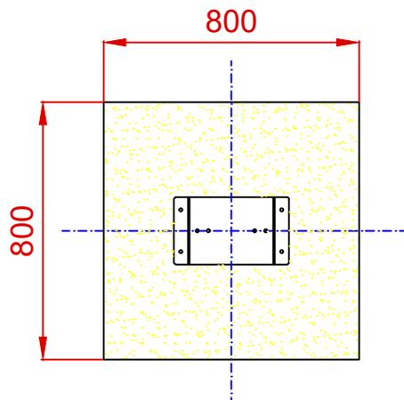
ESQUEMA DE CIMENTACIÓN EN HORMIGÓN
