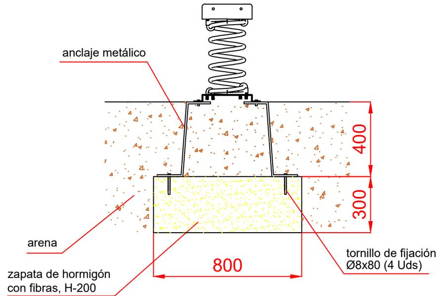
ESQUEMA DE CIMENTACIÓN EN HORMIGÓN
