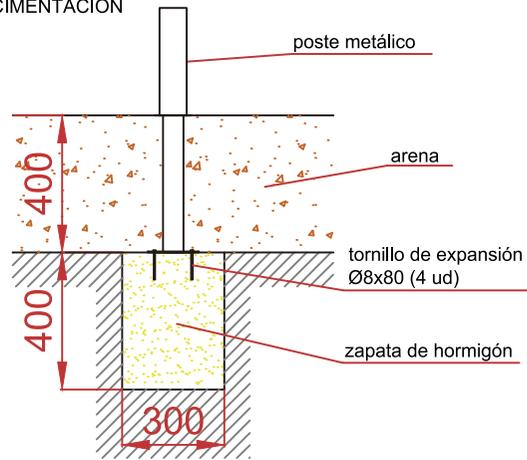
ESQUEMA DE CIMENTACIÓN EN HORMIGÓN
