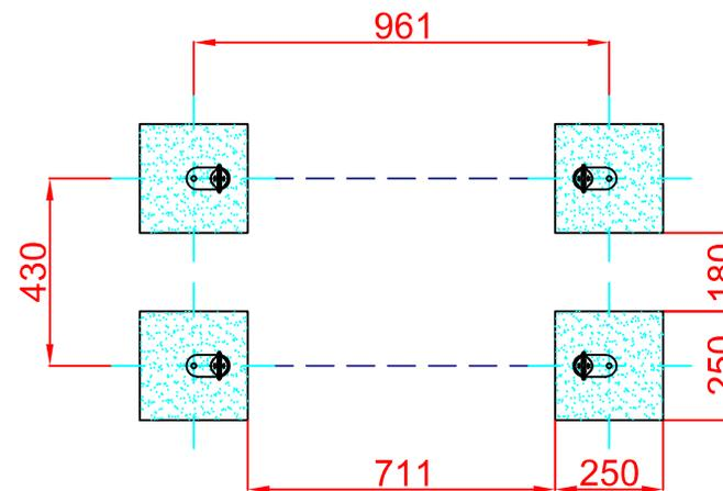
ESQUEMA DE CIMENTACIÓN PARA CASOS EN LOS QUE VA ATORNILLADO SOBRE SOLERA DE HORMIGÓN
