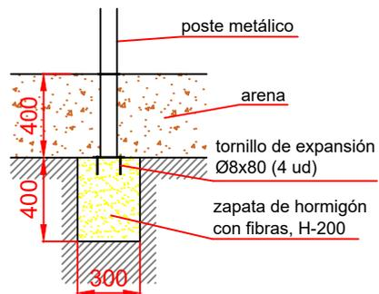
ESQUEMA DE CIMENTACIÓN EN HORMIGÓN
