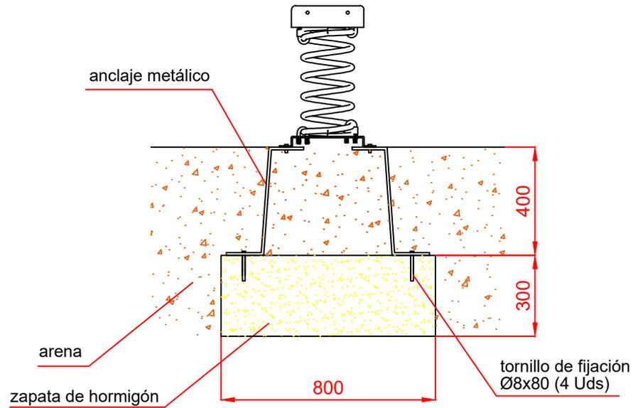
ESQUEMA DE CIMENTACIÓN EN HORMIGÓN
