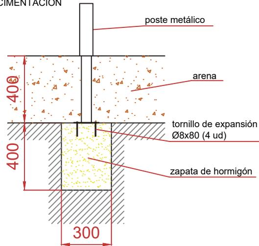
ESQUEMA DE CIMENTACIÓN EN HORMIGÓN
