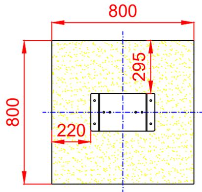
ESQUEMA DE CIMENTACIÓN EN HORMIGÓN
