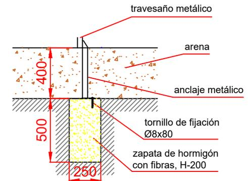
ESQUEMA DE CIMENTACIÓN EN HORMIGÓN
