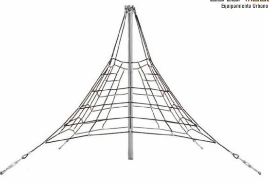
Altura libre de caída <1,50 m Edad recomendada de uso: de 3 a 14 años Fabricada con cuerda armada antivandálica Ø16 mm Conectores de Aluminio Barra termolacada en polvo con cápsula galvanizada en caliente
